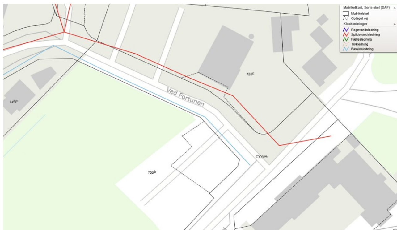
Figur 4 Eksisterende spildevandsledning beliggende på berørt matrikel
