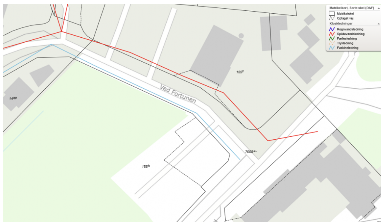
Figur 4 Eksisterende spildevandsledning beliggende på berørt matrikel
